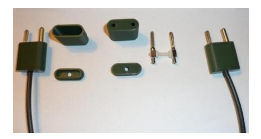
Hermann komplettierte dann die Gehäuseteile, lötete die Kabel an und füllte die Gehäuse mit Vergussmasse. Seine Freude über die nach seiner Ansicht gut gelungenen Stecker war sehr groß und eine Bestellung weiterer Gehäuse folgte bald.
