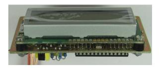
7. Wer will kann in die 10 Lötaugen für die diversen Anschlüsse auch Lötstützpunkte etc. einlöten (nicht im Bausatz enthalten). Das Gleiche gilt für den 6-poligen Programmiersockel. Dieser ist nur nötig, wenn man den Prozessor in dieser Platine programmieren will.
