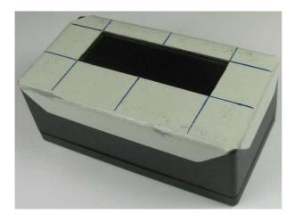
Hat man öfter solche Ausschnitte zu machen, bewährt es sich ein Stück Stahlblech mit z.B. 1 mm Stärke so zurechtzuschneiden und zu biegen, dass man es passgenau über das Gehäuse stülpen kann. Dieses versieht man auch mit dem passenden Ausschnitt als Vorlage. Nun kann man beliebig oft ein Gehäuse z.B. mit dem Fräsbohrer bearbeiten und den Rest mit der Feile erledigen ohne dass man jedesmal genau anzeichnen muss. Außerdem besteht nicht
