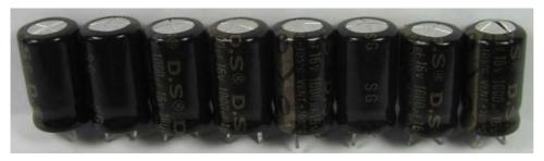
Beispiel für eine Serie Elkos aus einem defekten Motherboard. Einzig der ganz linke Elko ist OK, alle anderen haben aufgewölbte Oberflächen, was in einigen Fällen nur undeutlich zu erkennen ist. Der ganz rechts abgebildete Elko hat bereits ein aufgeplatztes Gehäuse.
