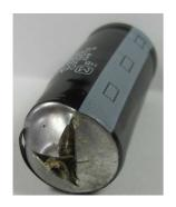
Beispiel für einen aufgeplatzten Elko. Man kann deutlich erkennen, das das Gehäuse exakt an der Sollbruchstelle platzte. Man sieht aber auch deutlich die zusätzliche Ausbuchtung links oben, unter der schwarzen Folie.
