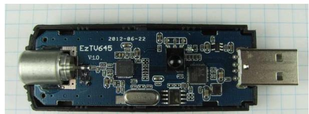
Als Tuner-Chip wird der **Fitipower FC0013** verwendet. Buchse: PAL Frequenzbereich offiziell geschätzte 25 MHz bis 900 MHz (Low-Bereich) und 1100 MHz bis 1800 MHz (High-Bereich). Preis < 20.-Euro
