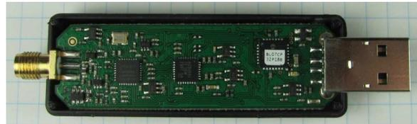
Dieser Stick wurde speziell für Amateurfunk entwickelt und gebaut. Er ist kein DVB-T-Stick und kann auch nicht als solcher verwendet werden.
