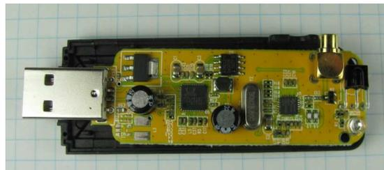
Als Tuner-Chip wird der **R820T** verwendet. Buchse: MMCX und Adapterkabel auf PAL Frequenzbereich offiziell 60 MHz bis 1700 MHz, Lücke bei 1000 MHz. Mit diesem Stick kann ich die Ausgabefrequenz von OE5XYP empfangen. Preis < 20.-Euro
