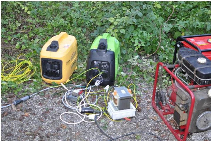
und drei mit Synchrongeneratoren, 2 mit den Leistungen von etwa 2000 VA und eines in Billigst-Ausführung mit etwa 650 VA(100€) sowie ein Sinus-Wechselrichter mit Ladeautomatik samt dazu passendem 200 Ah Blei-Gel-Akku. Das Ergebnis in Kurzfassung: Die beiden Inverter-Aggregate lieferten einen unerwartet sauberen Sinus
