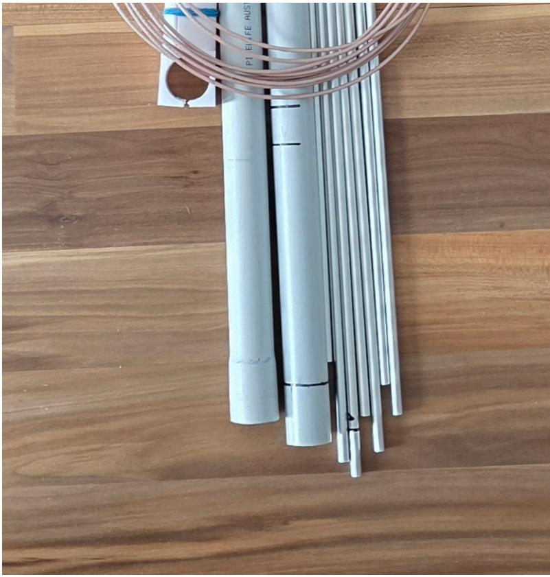
Das Ergebnis ist eine äußerst leichte und kompakte Antenne mit einem Gesamtgewicht von unter 1 kg und einem Packmaß von nur 103 cm – ideal für den Rucksack und auch für längere, anspruchsvollere Touren. In der Praxis hat sich diese Antennenlösung als sehr robust und leistungsfähig erwiesen.
